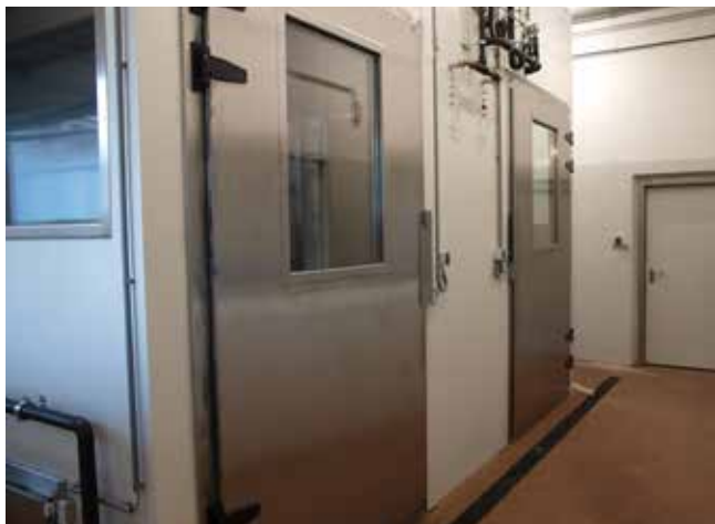
Respirationsskammern zur Messung der Methanemissionen
