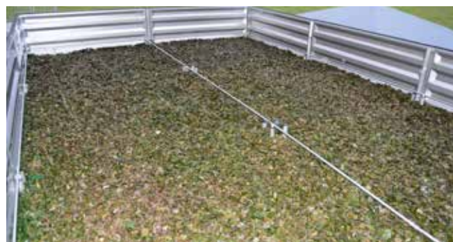
Abbildung: Einstufiger Rieselbettreaktor
